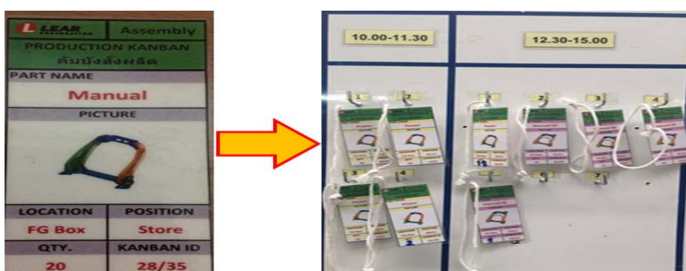
ภาพที่ 4-36 ตัวอย่างการใช้คัมบังสั่งผลิต
