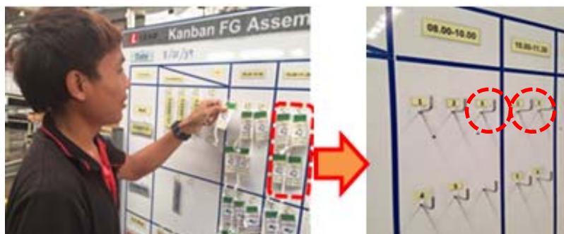
ภาพที่ 4-45 ตัวอย่างการหยิบบัตรคัมบังส่งผลิตจากบอร์ดคัมบัง
