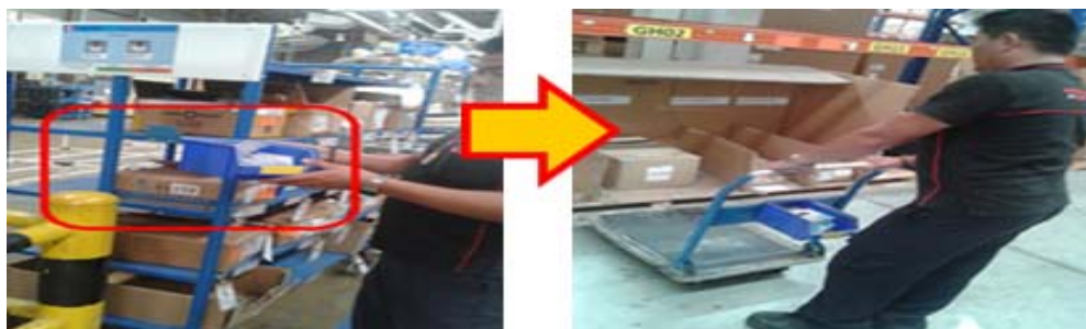
ภาพที่ 4-31 พนักงานตรวจกล่องพักคัมบังและนำบัตรคัมบังมาจัดเตรียมวัตถุดิบ
