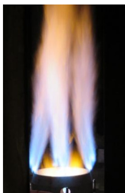
ภาพที่ 3-11 ภาพจริงแสดงการทำงานของหัวเผาไหม้ภายในเตากลั่นน้ำมันดิบ บริษัท ไทยออยล์ จำกัด (มหาชน)
