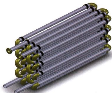
ภาพที่ 2-10 ตัวอย่างท่อ Convection coil (Newnham, 2013)
