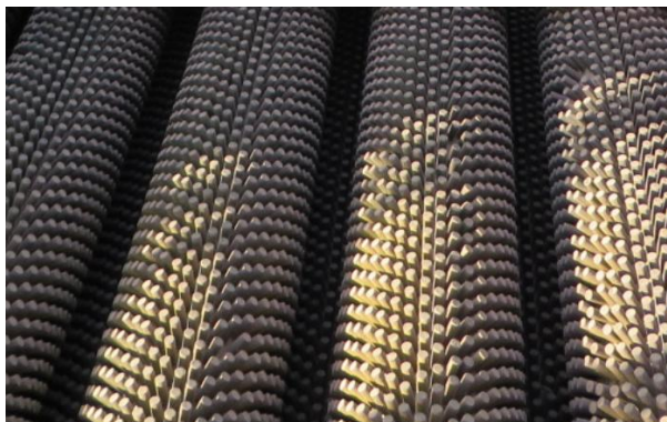
ภาพที่ 2-13 ตัวอย่างท่อแท่งโลหะ Studded tube บริษัท ไทยออยล์ จำกัด (มหาชน)
