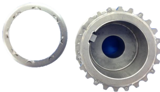
ภาพที่ 1-1 ลักษณะชิ้นส่วนประกอบของเฟืองเพลาค้อนเหวี่ยง
