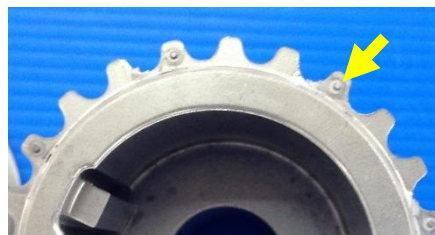
ภาพที่ 3-19 ลักษณะ Emboss ที่อยู่บนชิ้นส่วนผงโลหะอัดขึ้นรูป
