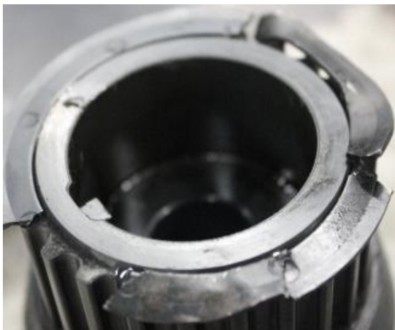
ภาพที่ 3-8 สภาพชิ้นงานแตกหลังจบการทดสอบในสภาวะการใช้งานจริง
