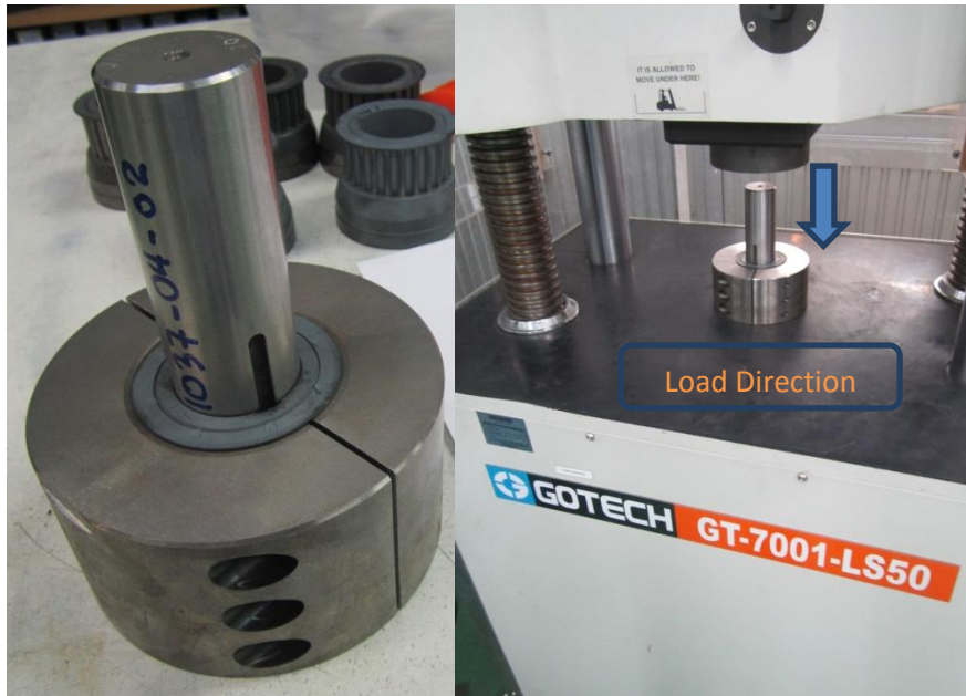
ภาพที่ 3-6 อุปกรณ์ยึดจับชิ้นงานสำหรับการทดสอบค่าความต้านทานแรงดึง
