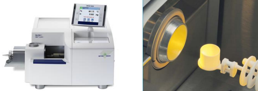
ภาพที่ 2-1 Thermal gravimetric analysis (TGA) (Mettler Toledo, 2016)
