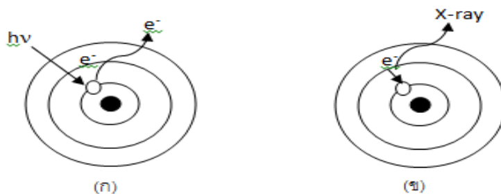
ภาพที่ 2-7 การเกิดรังสีเอกซ์ (ก) อนุภาคพลังงานสูงเข้าชน ทำให้อิเล็กตรอนชั้นในของอะตอมหลุดออกไป (ข) อิเล็กตรอนในชั้นถัดมาจะเข้ามาแทนที่พร้อมกับคายรังสีเอกซ์
