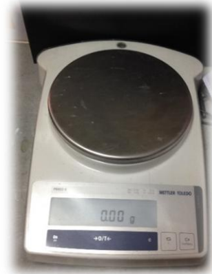
ภาพที่ 3 – 5 เครื่องชั่งดิจิทัล ที่มีค่าความละเอียด 0.01 g
