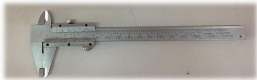
ภาพที่ 3 – 6 เวอร์เนียคาลิเปอร์ ที่มีค่าความละเอียด 0.02 mm
