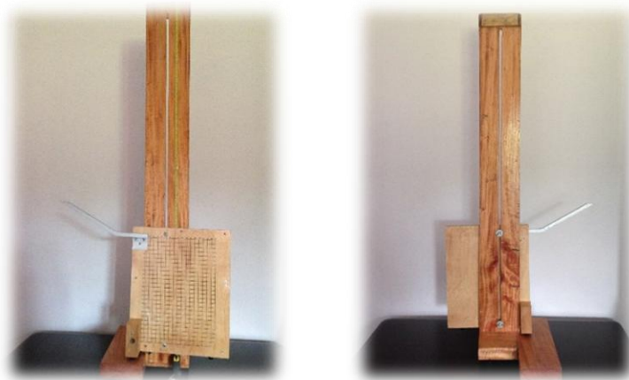
ภาพที่ 3 – 12 การนำชุดทดลองการเคลื่อนที่แบบโพรเจกไทล์ประกอบติดกับขาตั้งปรับระดับความสูง
