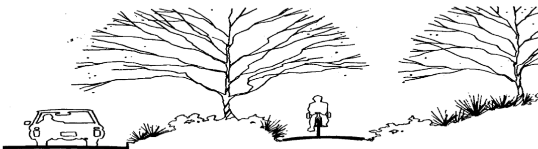
ภาพที่ 5 ทางจักรยานที่แยกเส้นทางเฉพาะออกการจราจรอื่น (Harris & Dines, 1988)
