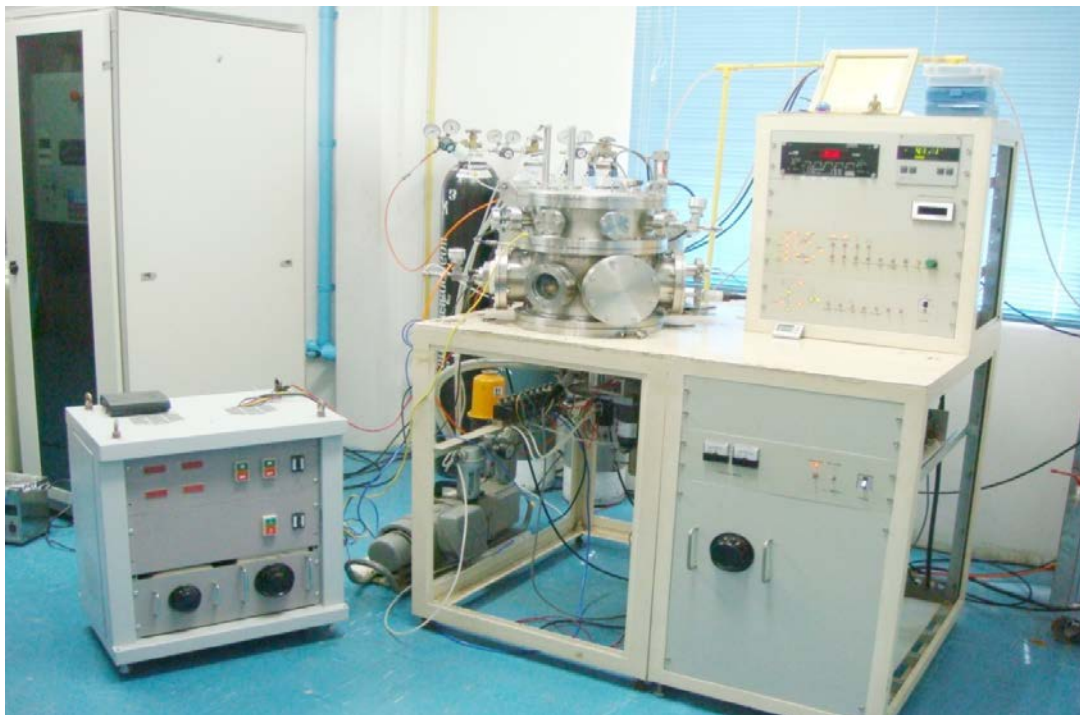
ภาพที่ 3-2 เครื่องเคลือบสุญญากาศระบบปริแอกตีฟ ดีซี แมกนีตรอน โคสปีดเตอริงที่ใช้ในงานวิจัย
