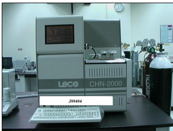
ภาพที่ 2-2 เครื่องการวิเคราะห์คาร์บอน ไฮโดรเจน ไนโตรเจน (ภาควิชาเคมีเทคนิค คณะวิทยาศาสตร์ จุฬาลงกรณ์มหาวิทยาลัย, 2558)
