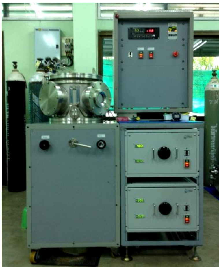
ภาพที่ 3-1 เครื่องเคลื่อนสุญญากาศระบบรีแอกตีฟดีซีแมกนีตรอน โคสปีดเตอริงที่ใช้ในงานวิจัย
