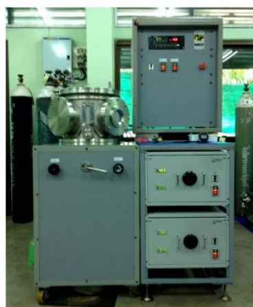
ภาพที่ 1 ลักษณะและไดอะแกรมของเครื่องเคลือบที่ใช้ในงานวิจัย
