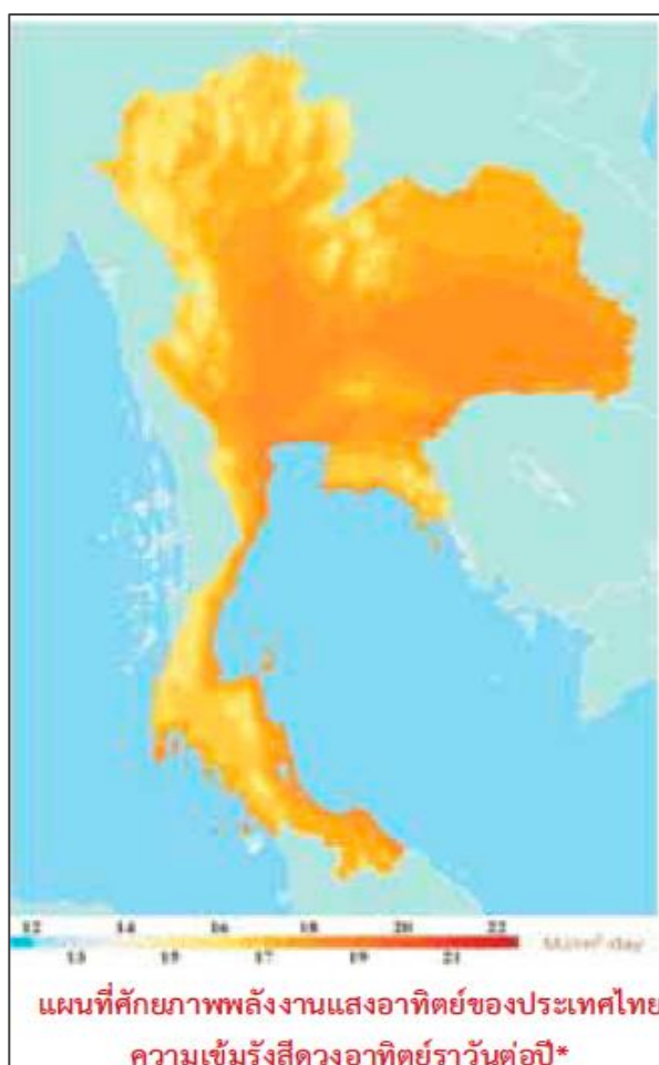
ภาพที่ 2-18 แผนที่ศักยภาพพลังงานแสงอาทิตย์ของประเทศไทย (กรมพัฒนาพลังงานทดแทนและอนุรักษ์พลังงาน, 2555)
