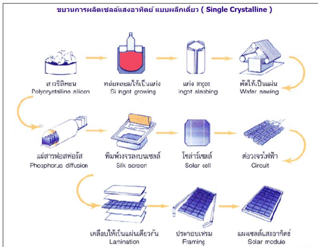
ภาพที่ 2-9 ขบวนการผลิตเซลล์แสงอาทิตย์แบบผลึกเดี่ยว (Single crystalline) (การไฟฟ้าฝ่ายผลิตแห่งประเทศไทย, 2552)
