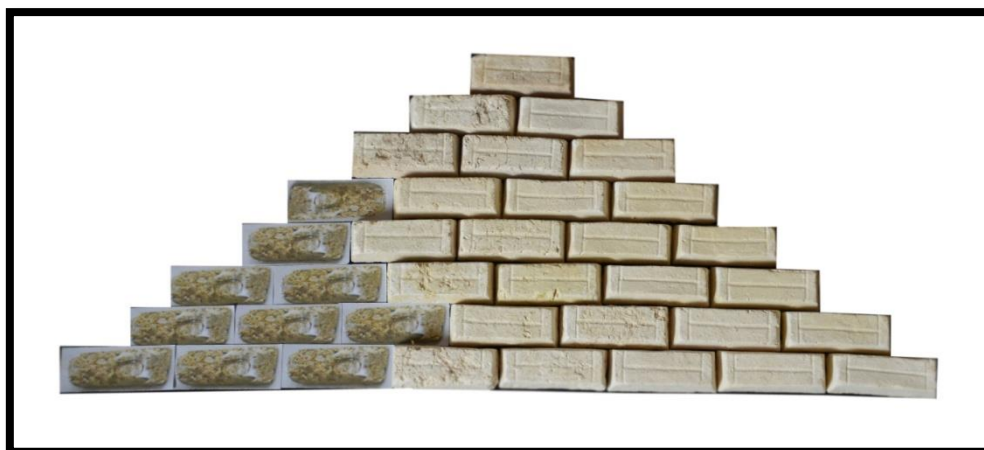
ภาพที่ 5-23 ลักษณะของซีเมนต์ทนไฟผสมเซรามิกไฟเบอร์ก่อนเผาที่อุณหภูมิ 1,200 องศาเซลเซียส (กฤตยชญ์ คำมิ่ง, 2557)
