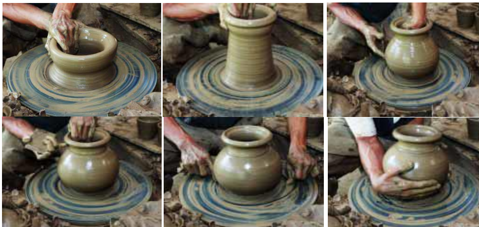
ภาพที่ 2-15 ขั้นตอนการขึ้นรูปบริเวณตัวของภาชนะดินเผา (กฤตยชญ์ คำมิ่ง, 2557)
