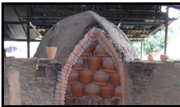
ภาพที่ 2-40 การจัดวางผลิตภัณฑ์เข้าเตาเผา (สุรัตน์ บัวหิรัญ, 2549)
