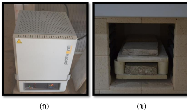
ภาพที่ 5-31 เตาไฟฟ้า (ก) ลักษณะภายนอกของเตา (ข) ลักษณะภายในของเตา (กฤตยชญ์ คำมิ่ง, 2557)
