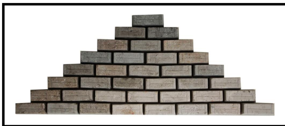
ภาพที่ 5-21 ลักษณะของซีเมนต์ผสมเซรามิกไฟเบอร์ก่อนเผา ที่อุณหภูมิ 1,200 องศาเซลเซียส (กฤตยชญ์ คำมีง, 2557)
