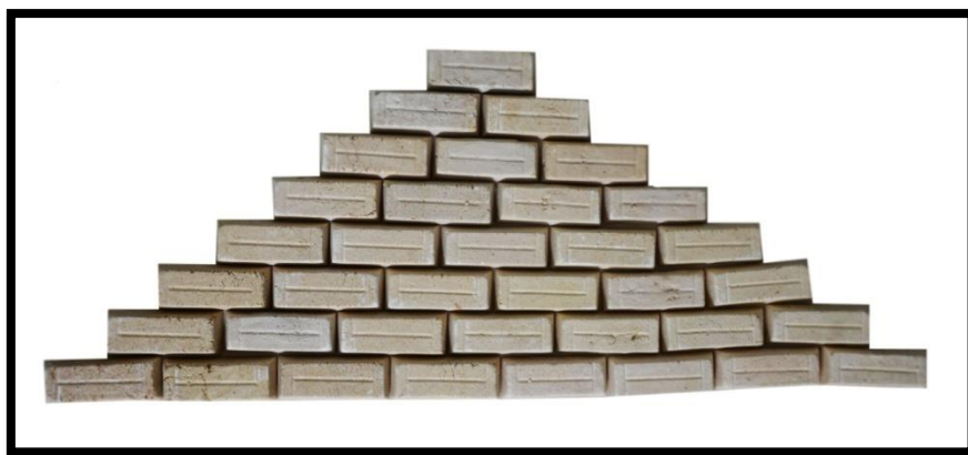
ภาพที่ 5-18 ลักษณะของซีเมนต์หลังเผา ที่อุณหภูมิ 1,200 องศาเซลเซียส (กฤตยชญ์ คำมิ่ง, 2557)
