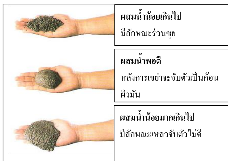
ภาพที่ 2-46 การผสมซีเมนต์ทนไฟ (www.tssrefractory.com)
