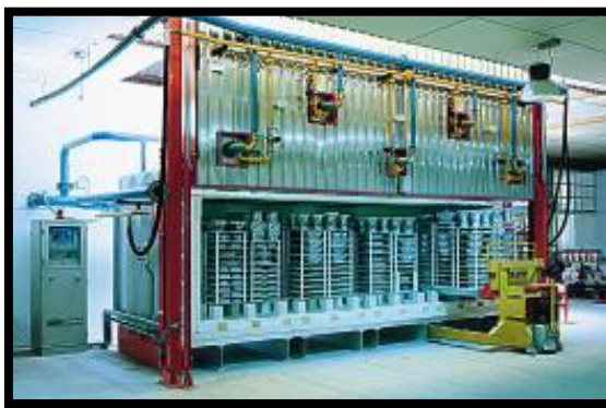
ภาพที่ 2-30 เตาเผาแบบไม่ต่อเนื่อง (www.ceradelindustries.com)
