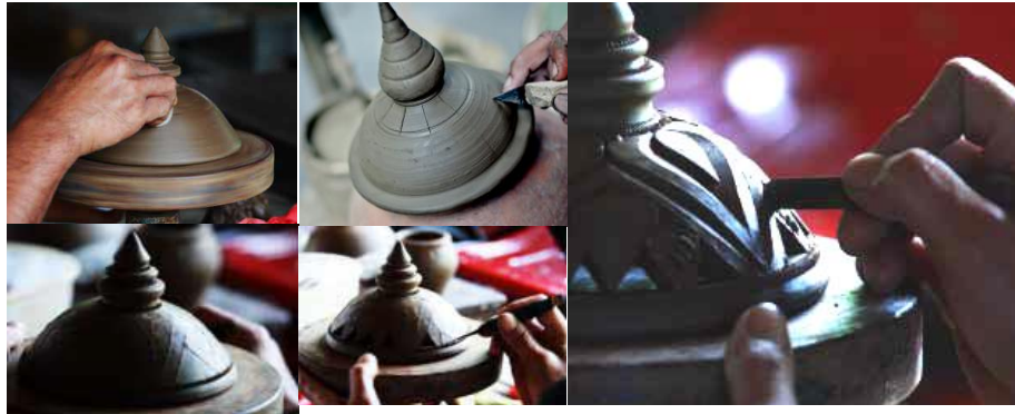
ภาพที่ 2-16 ขั้นตอนการแกะสลักภาชนะดินเผาเกาะเกร็ด (แกะสลักเครื่องปั้นดินเผาเกาะเกร็ด, 2557)
