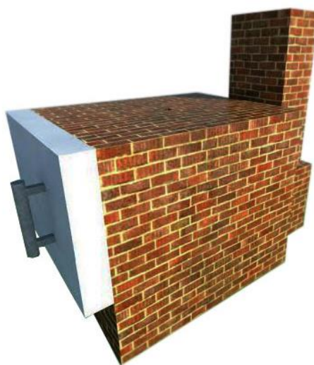
ภาพที่ 5-15 ลักษณะเตาแก๊สที่ได้รับการออกแบบใหม่ (กฤตยชญ์ คำมิ่ง, 2557)
