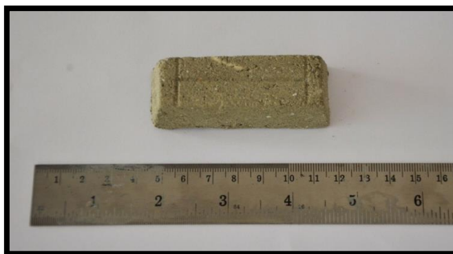
ภาพที่ 5-25 การวัดค่าการหดตัวของวัตดูคิบ (กฤตยชญ์ คำมิ่ง, 2557)
