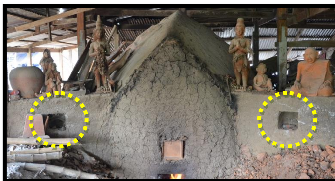
ภาพที่ 2-39 ช่องด้านหน้าเตาสำหรับใส่ของเช่น ไม้เตาเผา (กฤตยชญ์ คำมิ่ง, 2557)
