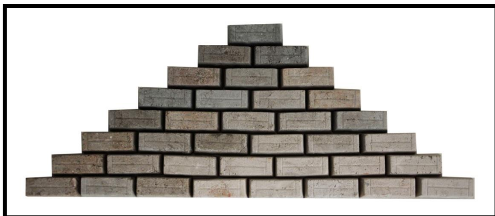
ภาพที่ 5-19 ลักษณะของซีเมนต์ทนไฟก่อนเผา ที่อุณหภูมิ 1,200 องศาเซลเซียส (กฤตยชญ์ คำมิ่ง, 2557)
