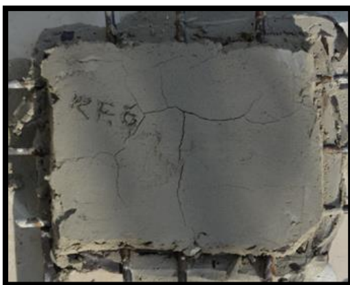
ภาพที่ 5-27 ลักษณะการเกิดรอยร้าวของวัตุดิบก่อนเผา (กฤตยชญ์ คำมิ่ง, 2557)
