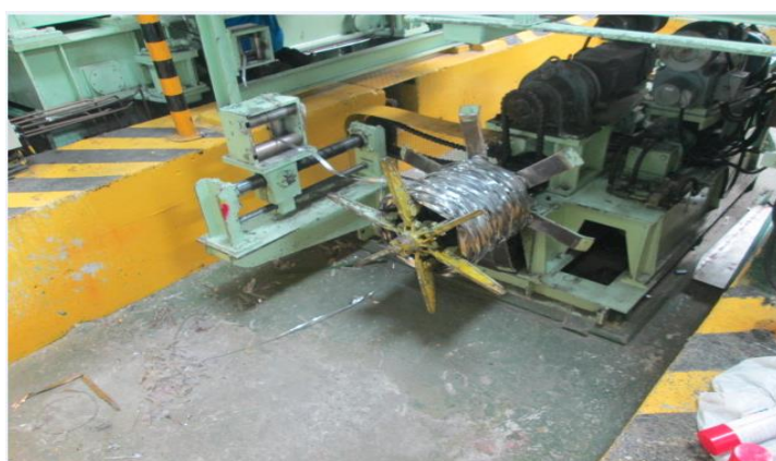
ภาพที่ 3 หลุม Scrap trimming
