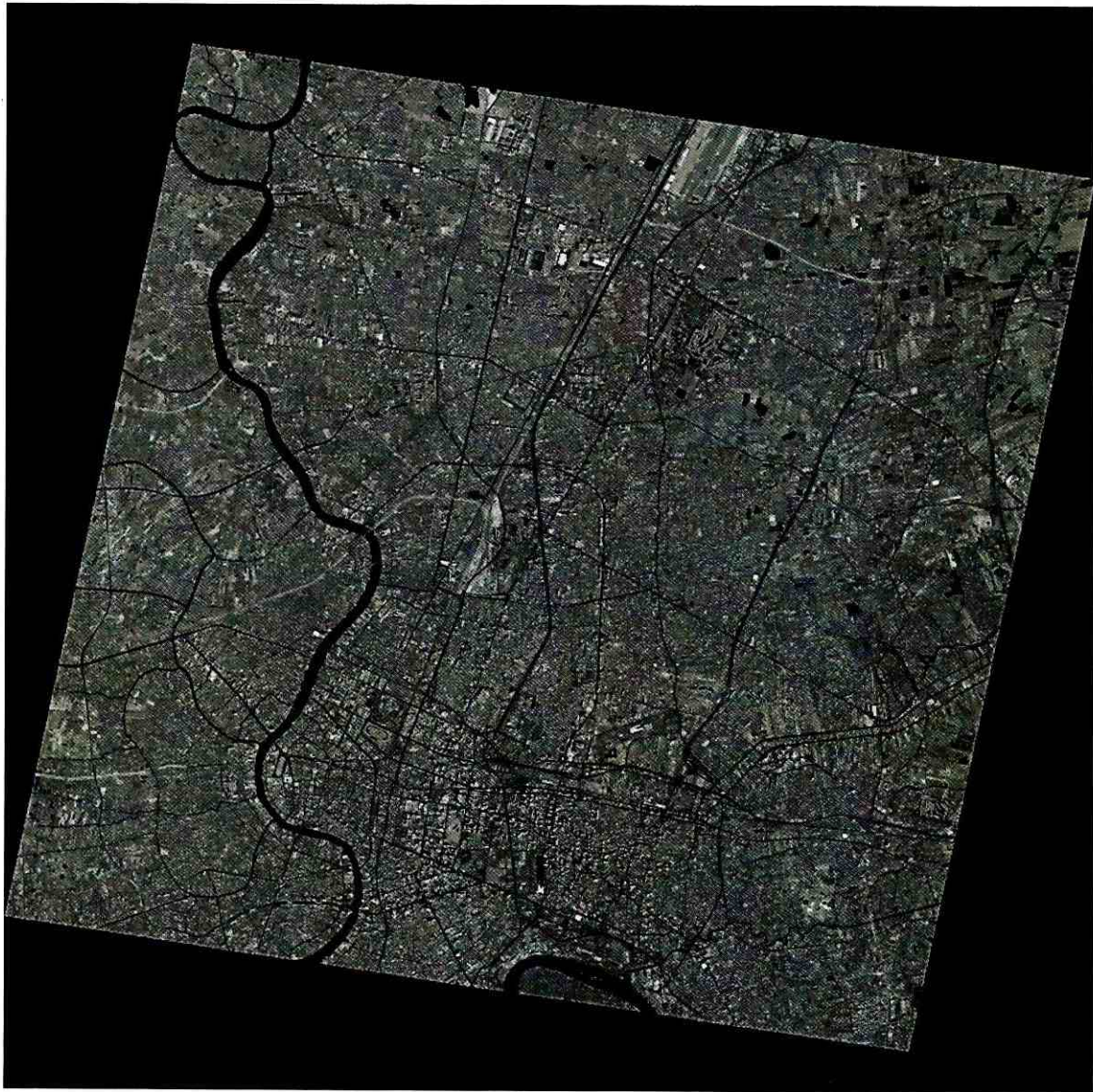
ภาพที่ 4-20 ความกว้างแนวบันทึกภาพที่มุม Roll 15 องศา และมุม Pitch คงที่ใกล้ Nadir
