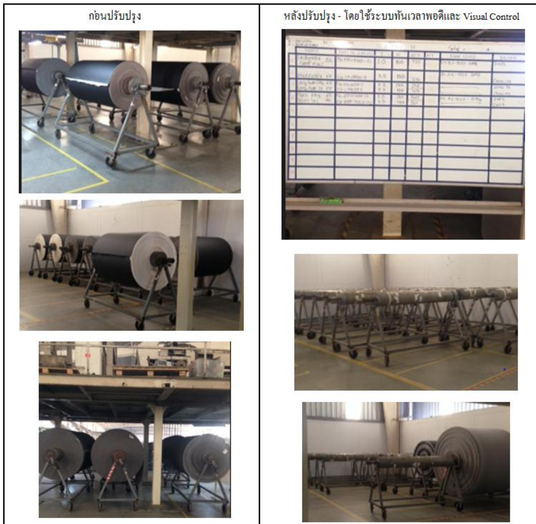
ภาพที่ 4-11 ใช้ระบบ Visual Control ในการควบคุมการผลิตของธุรกิจงานเคลือบ แสดงผล ก่อน-หลัง การปรับปรุง
