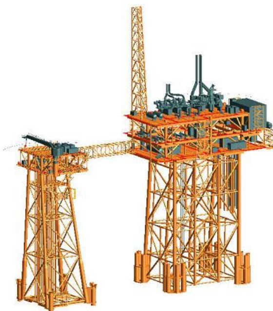
ภาพที่ 1-1 แนวคิดในการออกแบบแท่นหลุมผลิตก๊าซธรรมชาตินอกชายฝั่ง (Takla Corp., 2015)
