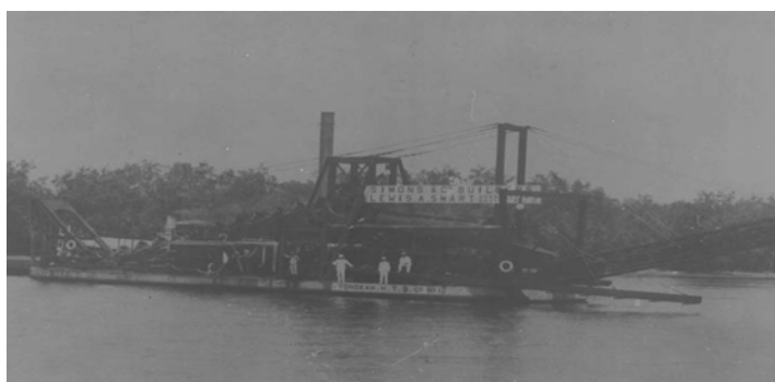
ภาพที่ 2-18 เรือดูดแร่ดีบุกลำแรกของโลก ดัดแปลงจากเรือขุดลอกร่องน้ำ (สมหมาย ปิ่นพุทธศิลป์, 2557)
