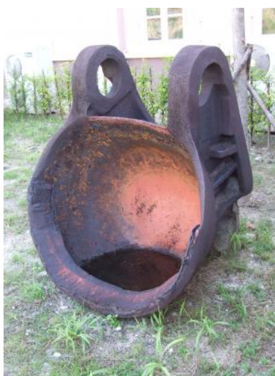
ภาพที่ 2-19 ลูกกระเชอหรือกะพ้อ อุปกรณ์ตักแร่ในเรือดูดแร่ (สมหมาย ปิ่นพุทธศิลป์, 2557)
