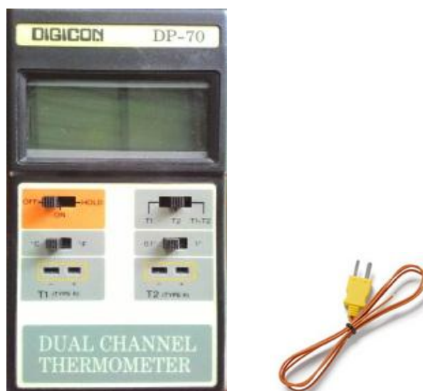
ภาพที่ 3-3 เครื่องมือวัดอุณหภูมิและสายเทอร์โมคัปเปิ้ลชนิดเค
