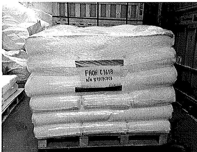
ภาพที่ 3-4 วางถุงผลิตภัณฑ์แพคเกจแอสลอสอลที่เรียงซ้อนกัน 6 ชั้น ชั้นละ 6 ถุง บนพาเลท โดยไม่ให้มีช่องระบายอากาศตรงกลางพาเลท
