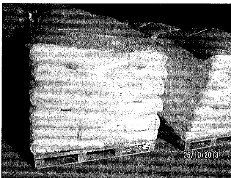
ภาพที่ 3-21 ขนาดของพาเลทที่ยาวขึ้นทำให้วางถุงผลิตภัณฑ์เฟดตีแอลกอฮอล์ได้จำนวนเยอะขึ้น คือ วางซ้อน 6 ชั้น ชั้นละ 6 ถุง
