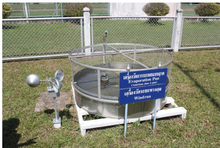
ภาพที่ 2-5 เครื่องวัดการระเหยแบบภาต (Evaporation Pan) ชนิด American Class A Pan
