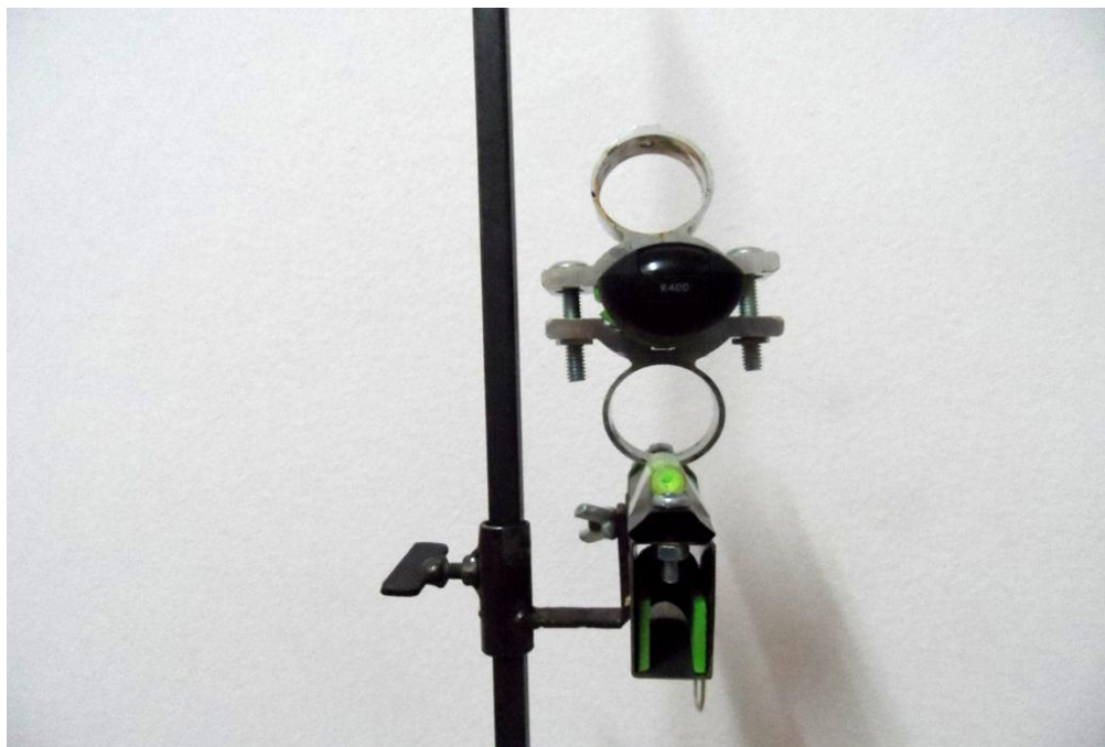
ภาพที่ 4-2 อุปกรณ์ประกอบชุดทดลอง แหล่งกำเนิดแสงเลเซอร์พอยเตอร์
