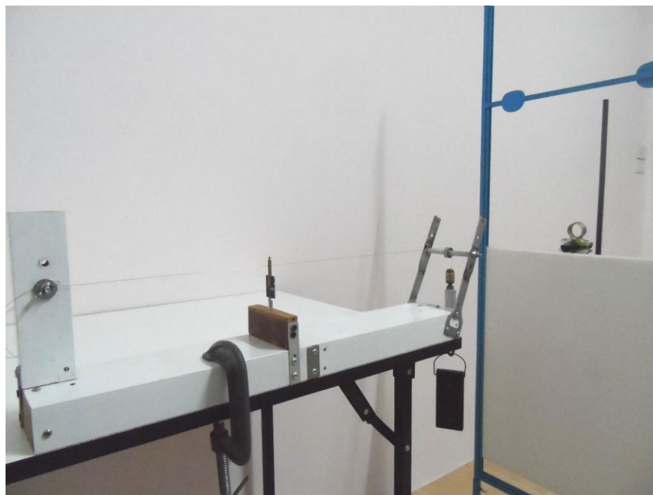
ภาพภาคผนวก ข-2 การตั้งชุดทดลองเพื่อหาค่ามอดูลัสของยังของลวดโลหะโดยใช้เทคนิคทางแสง
