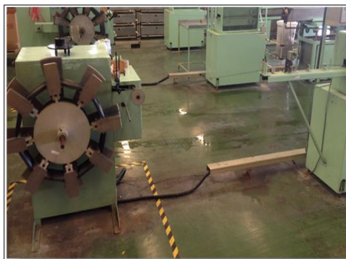
ภาพที่ 21 ขั้นตอนการนำลวดเกลียวผ่านกระบวนการเคลือบหุ้มผิว โดยผ่านรางน้ำเย็นเพื่อน็อค ระบายความร้อนเพื่อให้พลาสติกคงสภาพได้รวดเร็ว
