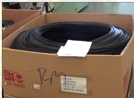
ภาพที่ 22 ขั้นตอนการนำดิ่ง Outer shield ผ่านเครื่อง Take off เพื่อจัดเก็บ Outer เข้ากล่องเพื่อรอส่ง กระบวนการถัดไป
