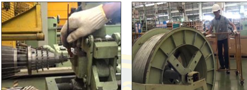
ภาพที่ 19 การต่อลวดเข้าหัวหนามเครื่อง TUBULAR เพื่อให้ลวดพันกันเป็นเกลียว
