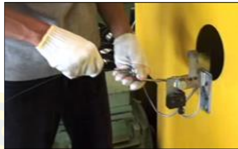
ภาพที่ 16 ขั้นตอนการเตรียม Liner มาใส่ Rolling เพื่อป้อนเข้าเครื่อง TUBULAR
