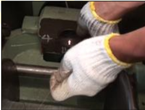
ภาพที่ 18 ขั้นตอนของการใส่ลวดที่อยู่ใน (Bobbin) เข้ามาใส่ในตัวเครื่อง
