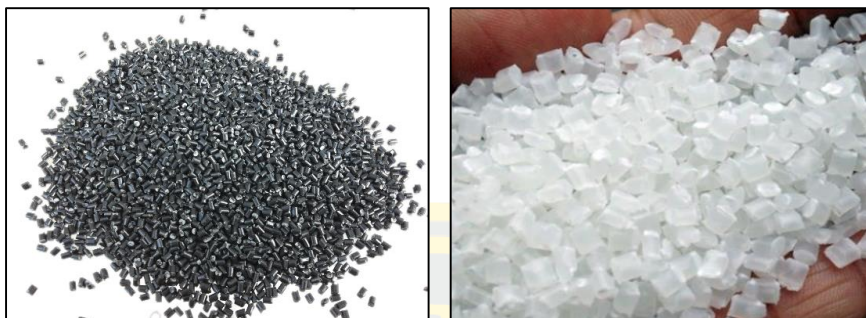
ภาพที่ 8 เม็ดพลาสติกชนิด PE
