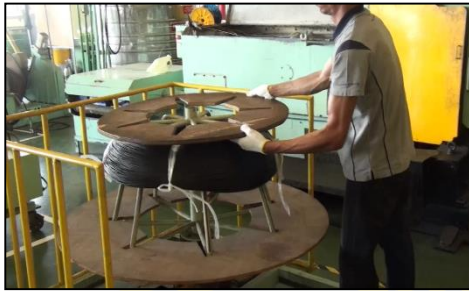
ภาพที่ 16 ขั้นตอนการเตรียม Liner มาใส่ Rolling เพื่อป้อนเข้าเครื่อง TUBULAR
