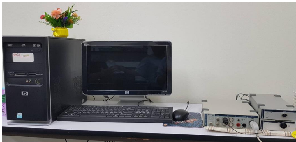
ภาพที่ 8 เครื่อง HRV module software รุ่น PowerLab 4/30 (ADInstruments, Australia) เป็นเครื่องมือสำหรับวัดความแปรปรวนของอัตราการเต้นของหัวใจ (Heart rate variability: HRV)
